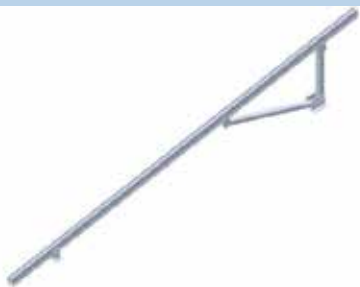
2.縦フレームの組み立て
