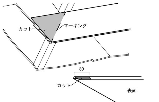
シーガード 本体を隅棟芯より10mmから20mm控えた位置でマーキングしカットします。シーガードCロック部(下段スレートへ差込部)を80mm程カットします。
