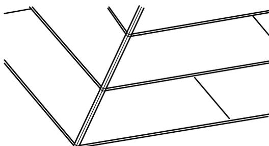
スレート 屋根材に接着剤を塗布しシーガード 本体を納めます。
